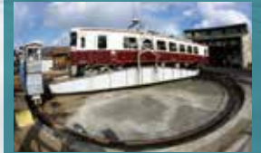
■転車台 蒸気機関車の車両の進行方向を変えるために造られた装置。
