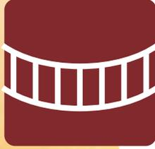
ワイヤロープを床版に沿って両サイドの橋台に張り渡し、橋を支える構造。主塔がないシンプルな構造のため、自然との一体感がより一層楽しめる。
