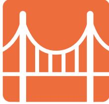
橋を吊るす「主ケーブル」の支点となる「搭柱」がある吊り橋。「高欄(手すり)」に使用する部材が、ワイヤロープではより視界が広く保たれ、鋼製パイプでは強度と安心感を創出。
