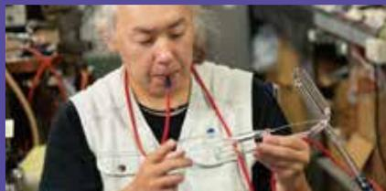
800℃の炎を放つガスバーナーでガラス管を自在に成形。二次元の図面を頭の中で三次元に変換、手作業で管を曲げていく熟練の技。
